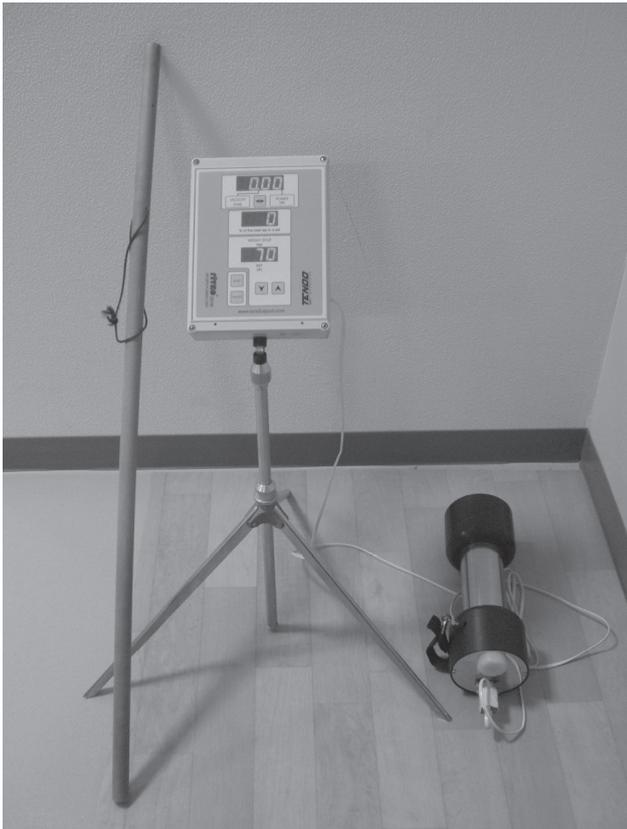
図1. 爆発的筋力測定器「フィットロダイナLED®」
