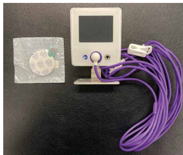
図2. 測定機器 ベアーハガー 深部温モニタリングシステム（3M社製）
