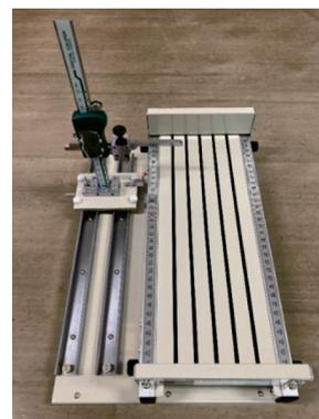
図 1. 足アーチ高測定器（竹井機器工業社製 T.K.K. 5831）
