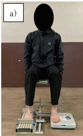
図2. 足部形態測定の荷重条件 a) 座位（10% 荷重）、b) 立位（50% 荷重）
