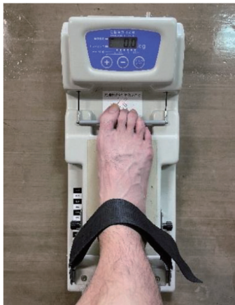
図1. 足趾筋力測定器Ⅱ（竹井機器工業社 T.K.K. 3364）
